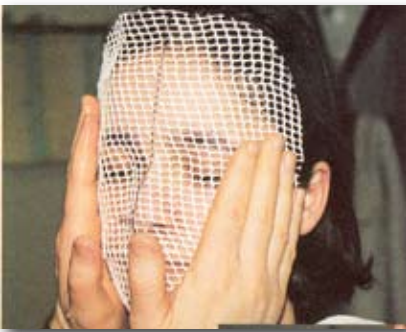
Varaform wordt verwarmd en kan direct op de huid gemodelleerd worden. Bij afkoeling is het materiaal stijf. Varaform is met PU-harsen, papier, lakken en verven etc. af te werken.
