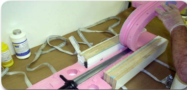
MoldMax Siliconen zijn uitermate geschikt voor allerlei moulage doeleinden. In het bovenstaande voorbeeld werd MoldMax 20 gebruikt om een flexibele doch zeer sterke mal te maken van een theater-requisiet.
