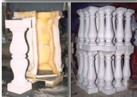
Productie van betonnen zuiltjes in PMC-121/50. Voor dergelijke mallen is een Shore A van 50 of harder aan te bevelen om de agressieve werking van het beton te weerstaan. Dergelijke mallen kunnen in een dagelijkse gietcyclus jarenlang meegaan. Doordat deze Polyurethanen vrijwel geen krimp vertonen zal een deskundig gemaakte mal een praktisch "naadloos" gietsel leveren.
