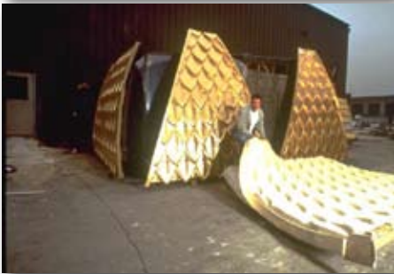
Vergulde, glasvezel versterkte betonplaten voor de top van het "Park Field House" in Chicago werden gemaakt met behulp van PMC-724 mallen.
