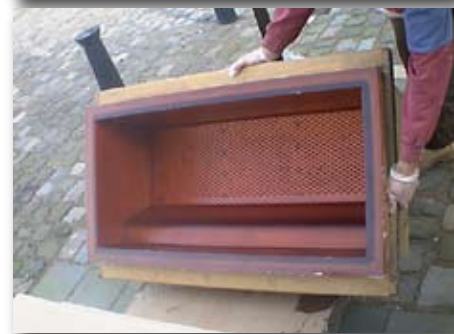
boven: Mal van PMC-121/50 voor de productie van stoepranden in beton. onder: PMC-121/30 is favoriet voor de productie van ornamenten en lijstwerk in gips, van het beton te weerstaan. Dergelijke mallen kunnen in een dagelijkse gietcyclus jarenlang meegaan. Doordat deze Polyurethanen vrijwel geen krimp vertonen zal een deskundig gemaakte mal een praktisch "naadloos" gietsel leveren.
